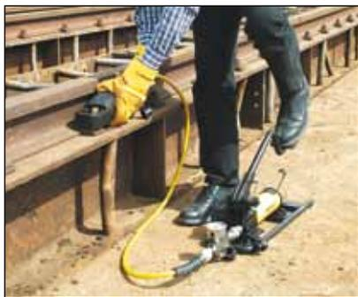
◀ Легкое удаление ржавых гаек при строительстве железнодорожных путей – лишь одна из областей применения гайкореза Enerpac.
