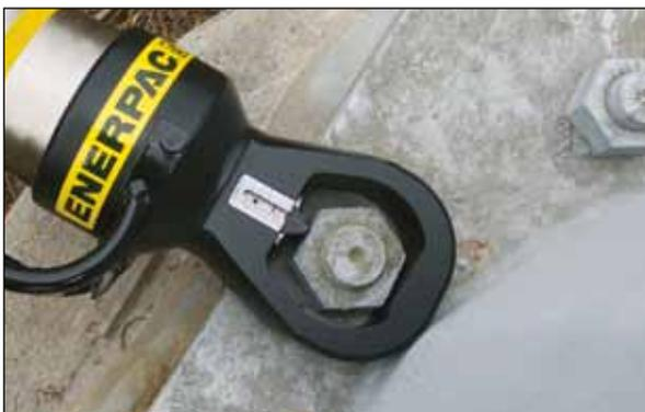
◀ Сильно заржавевшие и изношенные гайки легко срезаются и удаляются при помощи гайкореза серии NS.
