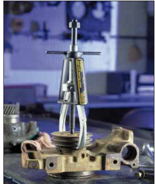
▲ Съемник EP-204 с двумя захватами, установленный для вытаскивания приводного шкива водяного насоса.
